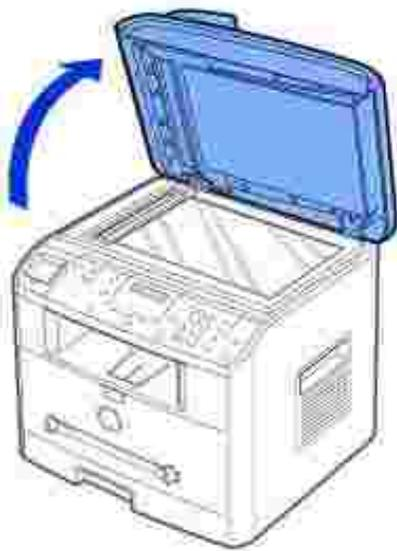
3. Pulire la superficie del vetro dello scanner e del vetro dell'ADF finché non è pulita e asciutta.
