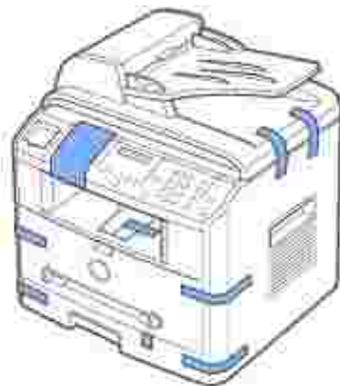
5. Rimuovere completamente l'etichetta dal modulo dello scanner tirandolo con cura. Il pulsante di sbloccaggio dello scanner si sposta automaticamente IN AVANTI fino alla posizione di sbloccaggio.
