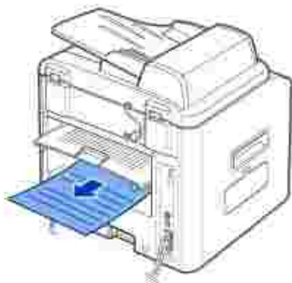
Stampando dall'alimentazione manuale sulla fessura di uscita posteriore si fornisce un percorso della carta diretto. L'uso della fessura di uscita posteriore potrebbe migliorare la qualità della stampa con i seguenti supporti:
